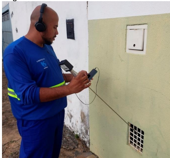
Imagem 10 – Uso de haste de escuta eletrônica
